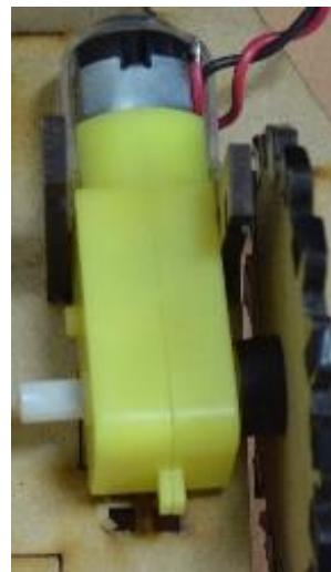
Motorreductores acoplados a las ruedas
