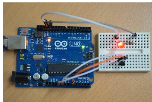
El LED se enciende cuando el sensor LM35 detecta temperaturas mayores a 25 [°C]
